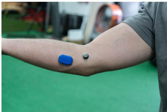
**Abbildung 3.4:** Befestigung der *motusBASEBALL* IMU (blau) am Wurfarm in [BMC<sup>+</sup>19]
