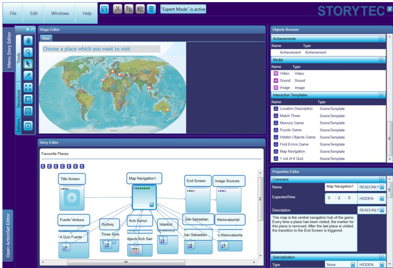
Abbildung 1 Die Benutzeroberfläche des Autorensystems StoryTec. Die Struktur des gesamten Spiels wird links unten abstrakt dargestellt, während die Konfiguration einer konkreten Spielszene im linken oberen Bereich angeordnet ist.
