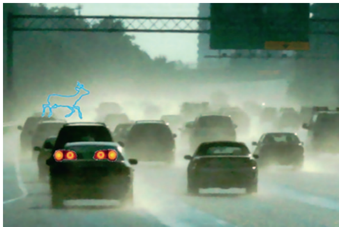
Abbildung 4: Fahrerassistenz durch Einblenden möglicher Gefahrensituationen
